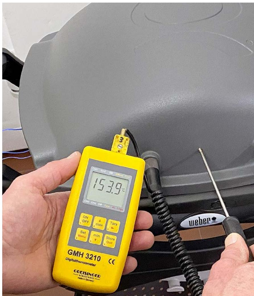
Weber-Grill im Labor: Deckel wird im Betrieb sehr heiss
